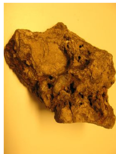
Illustration 14: Småstenen var inbäddad i en stelnad, klistrande gatubeläggningen
